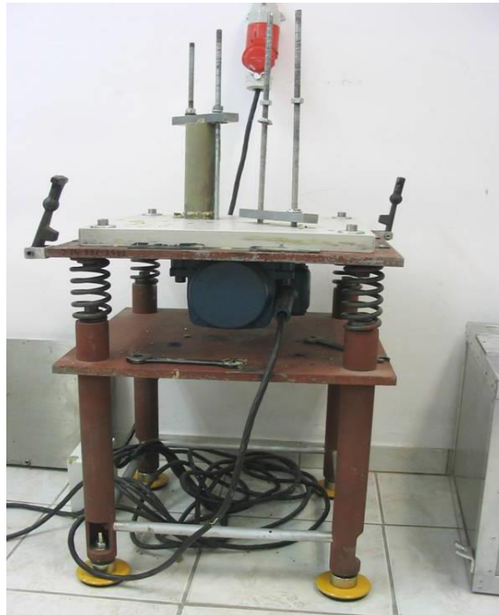
Rys. 5.2.3. Stół wibracyjny wraz z zamontowaną formą napełnioną materiałem modelowym
