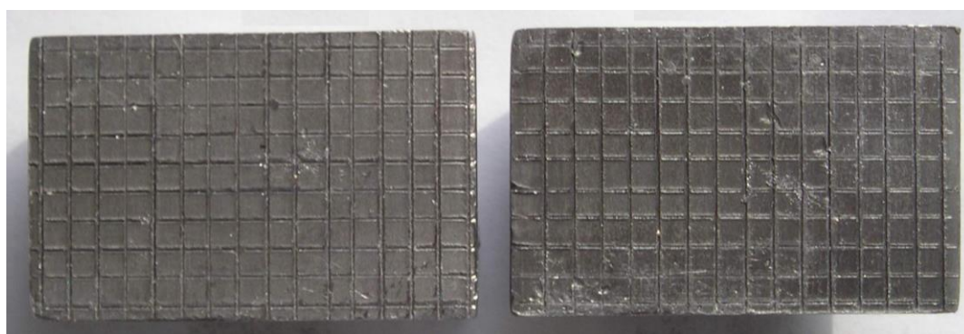
Rys. 6.5.4. Próbkę ołowiu z siatką koordynacyjną przed wyciskaniem
