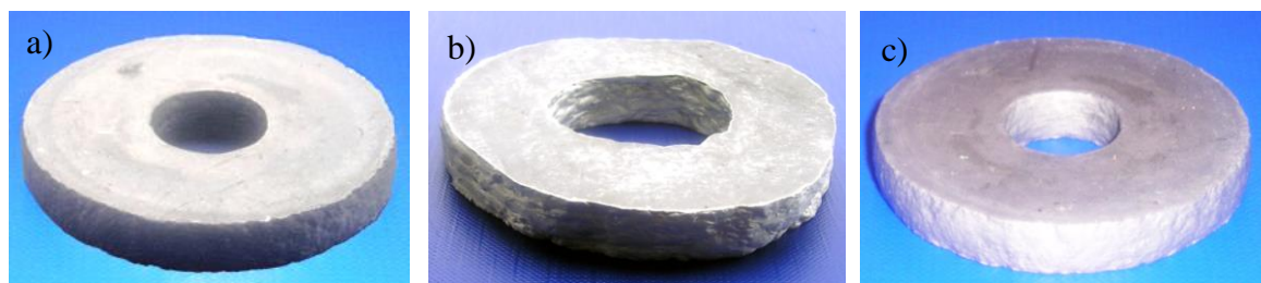
Rys. 6.3.1. Zdjęcia odkształconych próbek w próbie pierścieniowej: a) ołów, b) aluminium umocnione i c) aluminium wyżarzone
