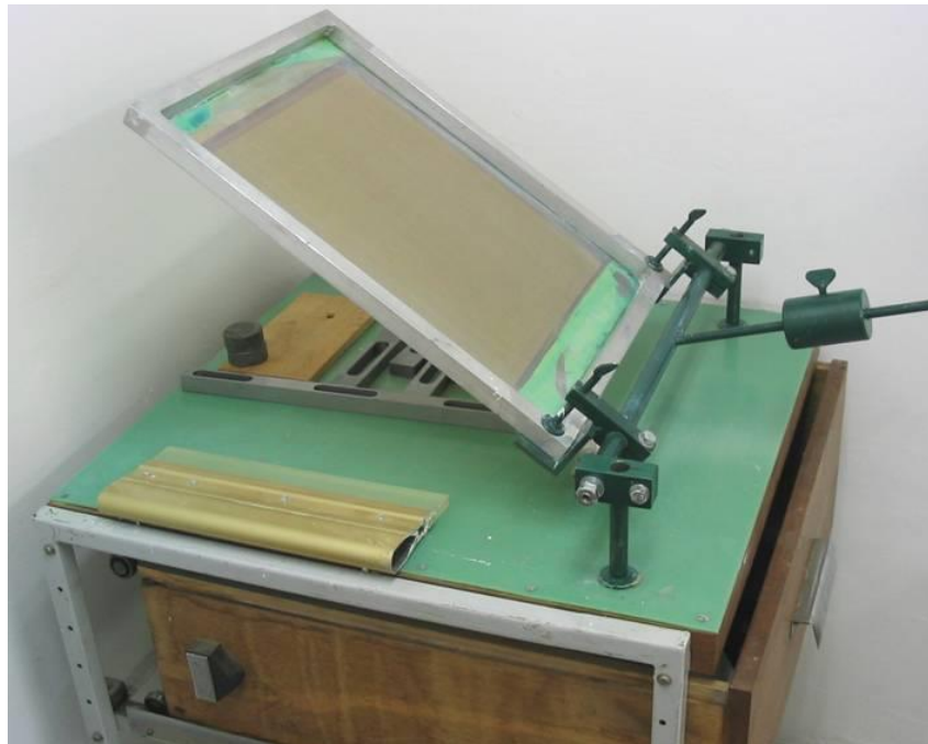
Rys. 5.2.5. Stanowisko do nanoszenia siatek koordynacyjnych metodą sitodruku
