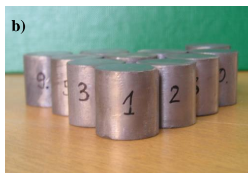
Rys. 6.2.2. a) Zdjęcie stanowiska do realizacji próby śpężania oraz b) zestaw próbek
