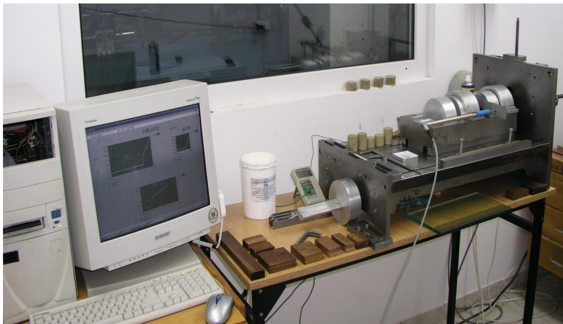
Rys. 5.2.2. Zdjęcie stanowiska do realizacji eksperymentów przy użyciu materiałów modelowych
